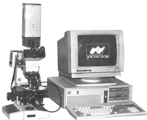
测量范围: 10nm~2000nm 测量精度: 1nm
