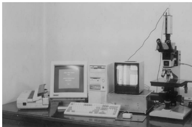
测量分辨率: 0.01 \mu m 测量精度: \pm 0.05\mu m
