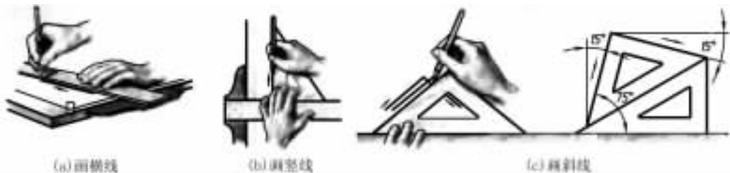
图 员- 员燥图板、丁字尺和三角板的使用
