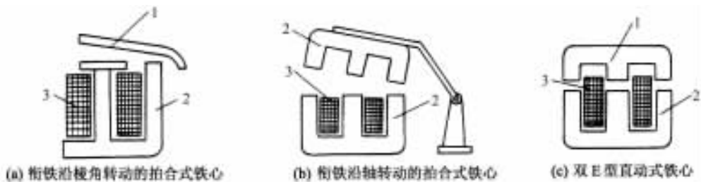
图 1-3 常用的磁路结构
