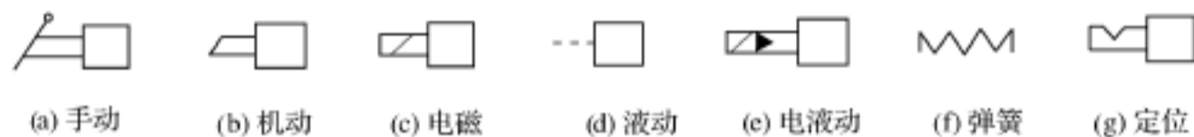
图 1 - 7 换向阀操纵方式符号
