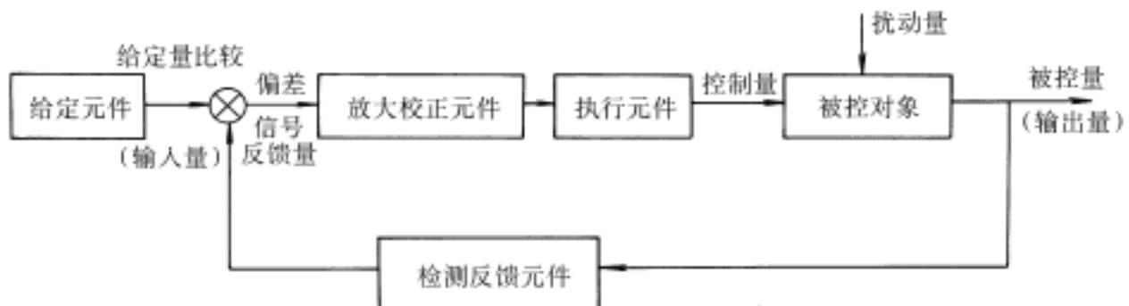
图 16—5 闭环控制系统基本组成
