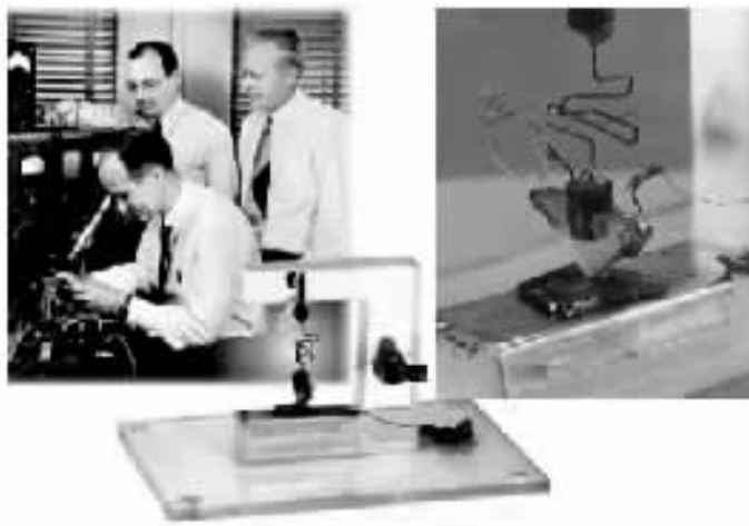
图 1.1 Shockley 三人小组和世界上第一只晶体管 (三人坐着为 Shockley, 后面从左分别为 Bardeen 和 Brattain)
