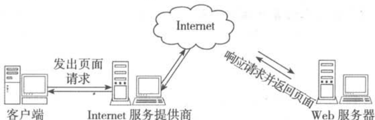
图 1—1 Web 服务器的工作原理
