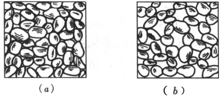
图 1-4 单粒结构 (a) 紧密结构；(b) 疏松结构
