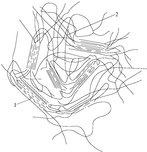
图 圆园圆 摇结晶型聚合物结构示意图 员—晶区；圆—非晶区
