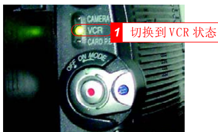
图1-21 将电源开关设定于VCR位置
