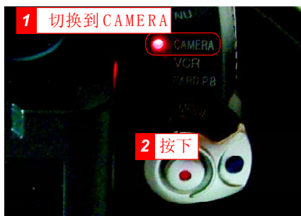
图1-18 将电源开关切换到CAMERA
