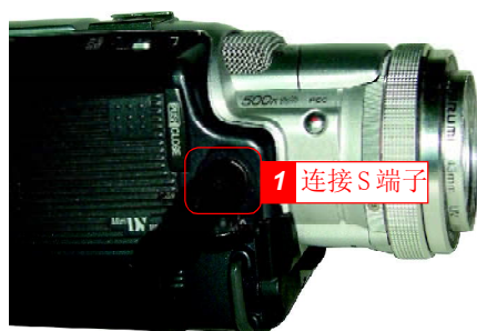
图1-23 连接S端子连接线
