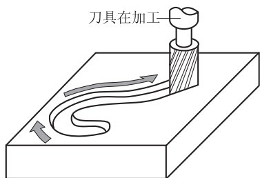
图 1-6 轮廓控制数控机床的刀具轨迹
