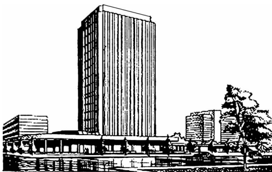
图 1-3 用中心投影法绘制的图样
