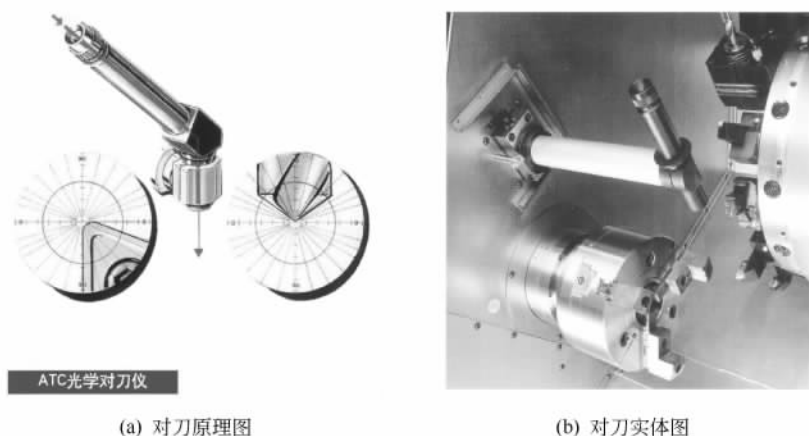
图 1-5 光学检测对刀仪对刀
