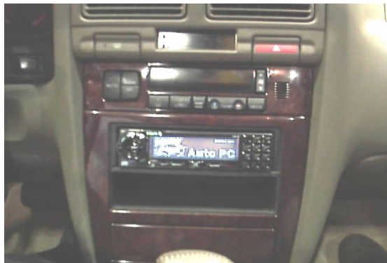
图 1-2 Auto PC 可以装置在车上，而且可以使用 Windows CE 的手持装置与其沟通
