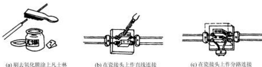
图 1-4 单股铝导线的螺钉压接法
