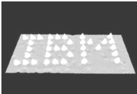
图 1-3 世界上最小的原子商标——由 35 个氩原子在镍（110）单晶表面组成（液氮温度下）
