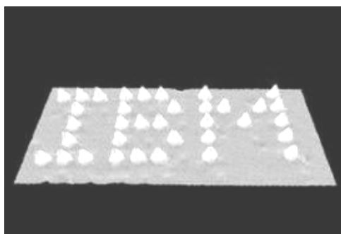
图 1-3 世界上最小的原子商标——由 35 个氦原子在镍（110）单晶表面组成（液氦温度下）
