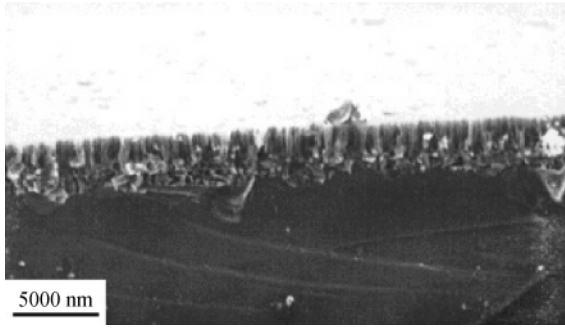
图 1-1 单晶基底上直立生长的纳米线的横截面图
