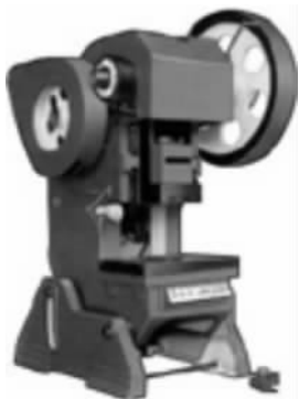
图 4-2 开式曲柄压力机
