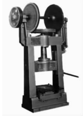
图 员 摩 擦 压 力 机 工 作 原 理 图
