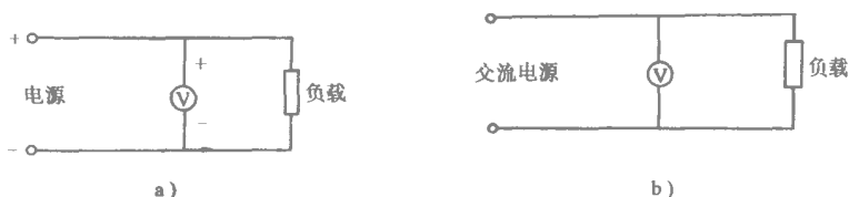
图 1-10 a) 直流电压表接线图 b) 交流电压表接线图
