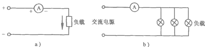
图 1-7 a) 直流电流表的接线 b) 交流电流表的接线
