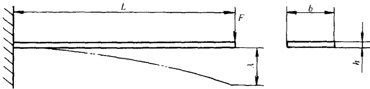
图 1-8 片簧的刚度计算简图
