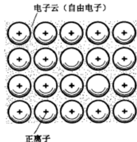
图 1.1 金属键模型示意图
