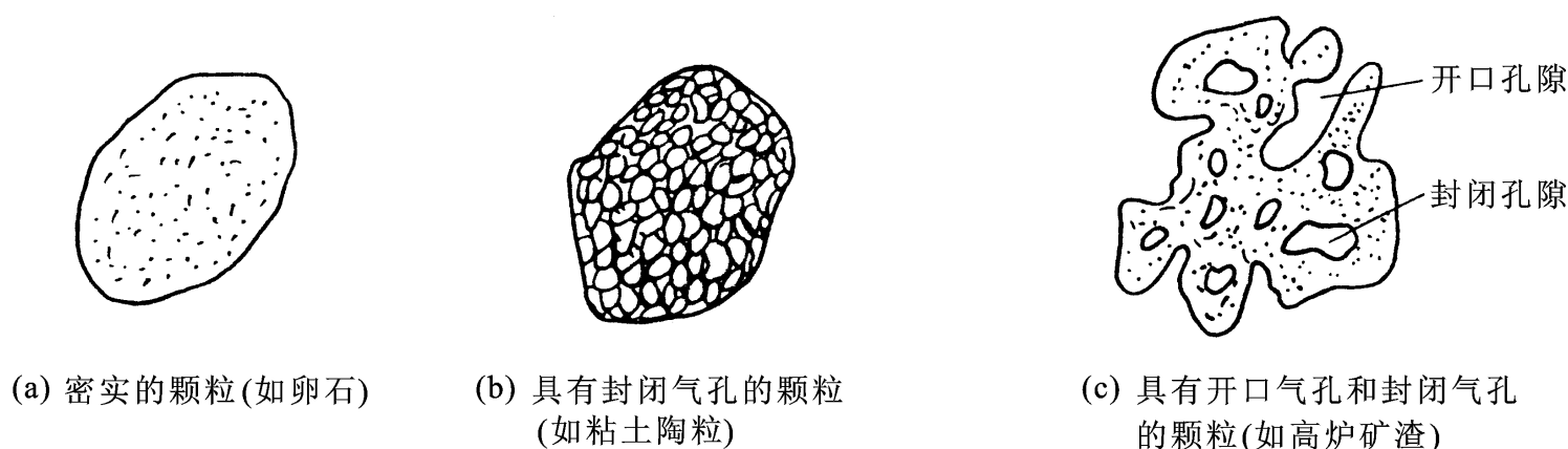
图 2 - 1 颗粒材料孔隙形状特征
