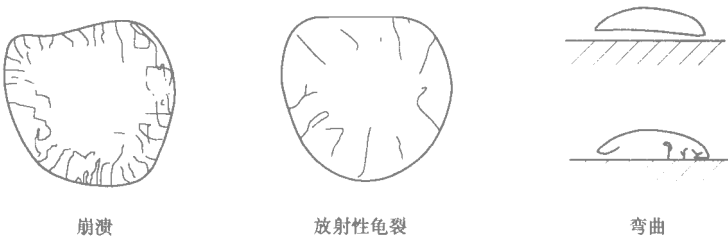
图 1-11 安定性不合格的试饼
