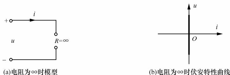
图 1-15 电阻为 \infty 时的电路模型及伏安特性曲线
