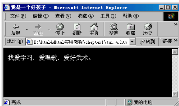
图 1.4 改变<body> 标记符中的 bgcolor 属性和 text 属性
