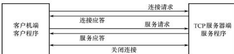
图 8.2 使用 TCP 传递数据的客户机/服务器模型
