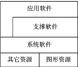
图 1.3 单主机模式计算机图形系统的软件组成
