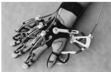
图 1-2 虚拟现实中的数据手套的实例
