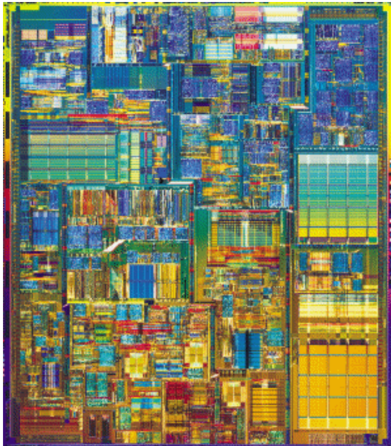
图 1.6 英特尔公司 2000 年推出的 Pentium ( 奔腾 ) 4 微处理器芯片
