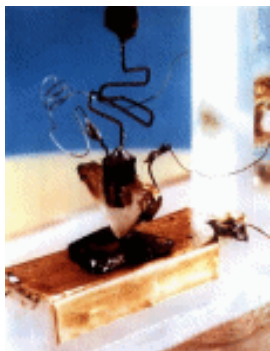
图 1.1 最原始的点接触式晶体管
