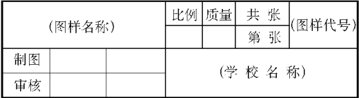
图 员原原 制图作业用简化标题栏
