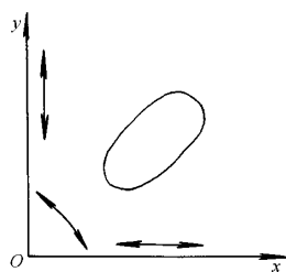
图 2-7 平面构件的自由度
