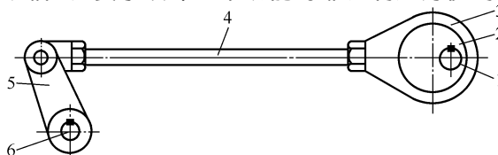
图 1-12 摇偏心轮连杆机构
