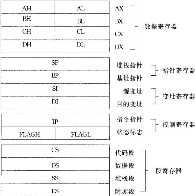
图1-4 8086/8088CPU的寄存器结构
