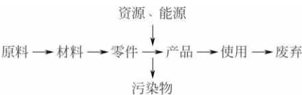
图 2-1 一般工业产品的链式生产流程图
