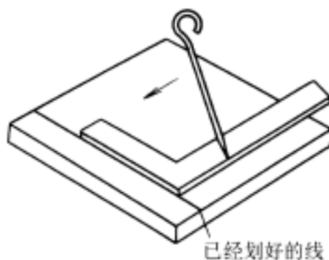
图 2.10 用直角尺划垂直线
