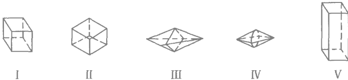
图 2-2 硝酸铵五种晶体形状
