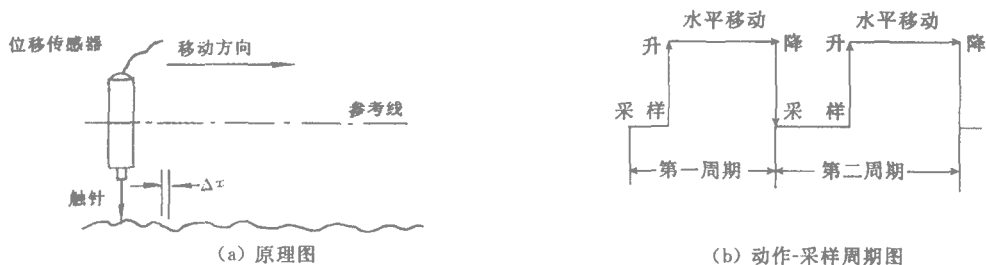
图 2-2 RSP-I 型智能岩石表面形态仪原理及动作-采样周期图
