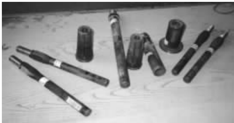
图 1 缘型式试验后自力式 悦爱蜡想原悦整体触头的外观形貌
