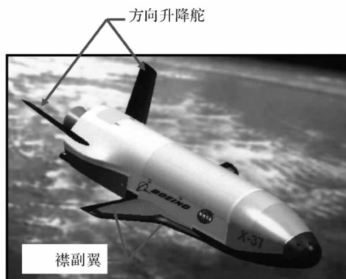
图 1.6 X—37 陶瓷基复合材料的襟副翼和方向升降舵
