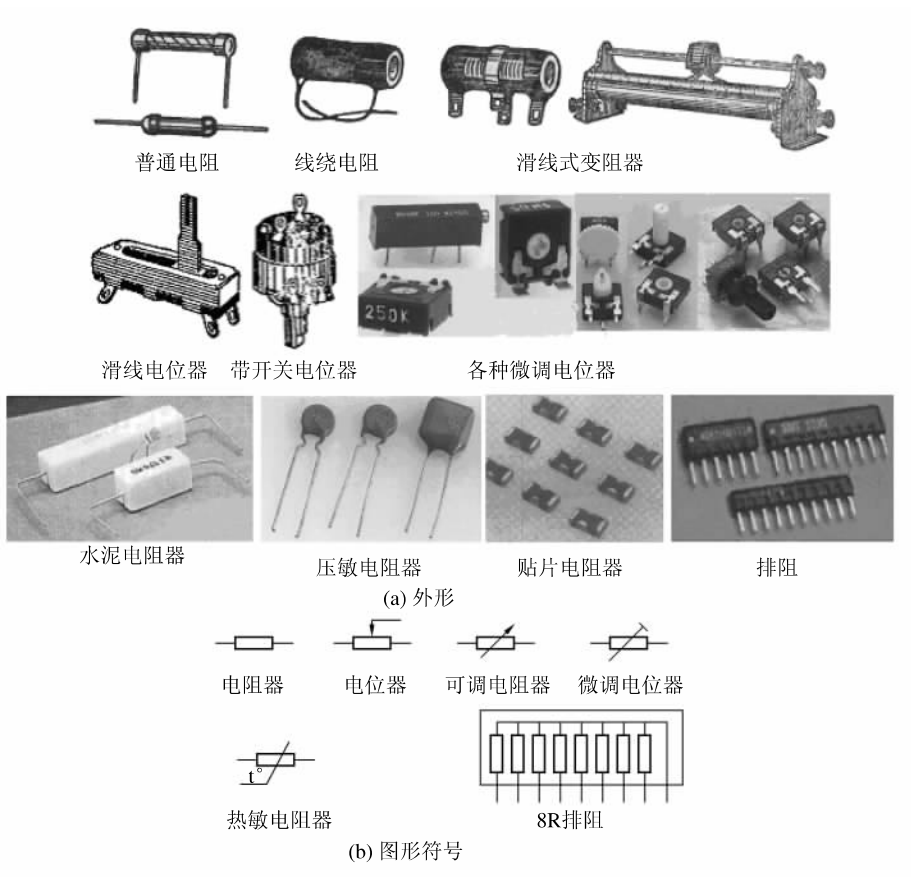
图 1-1 部分电阻器外形及其图形符号
