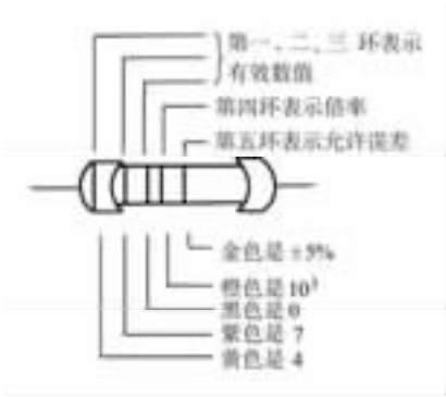
图 员圆 五色环电阻器的标注
