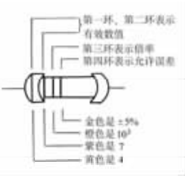
图 员圆 四色环电阻器的标注
