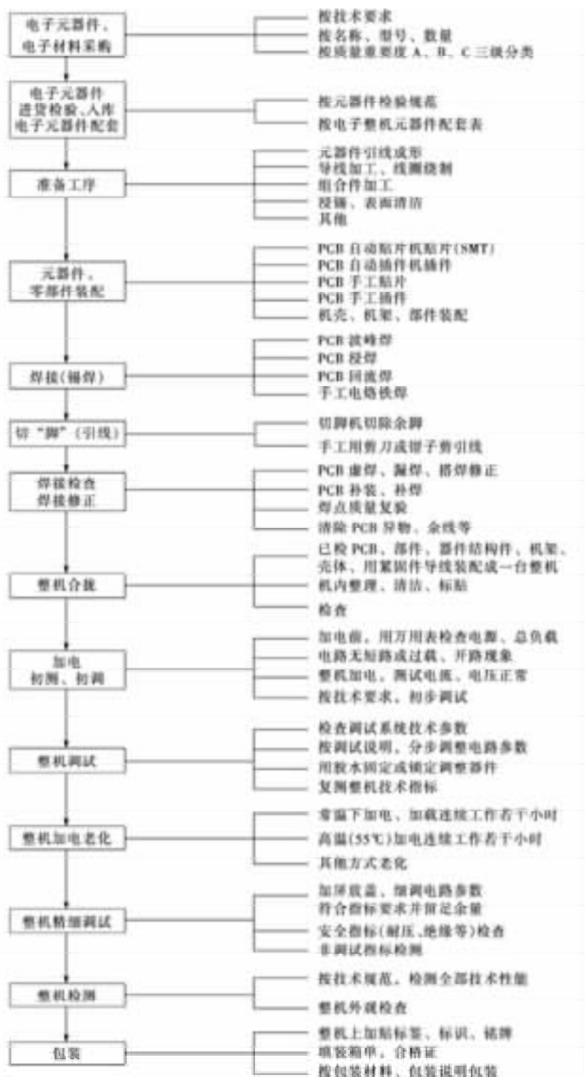
图 9-1 电子整机产品制造流程图
