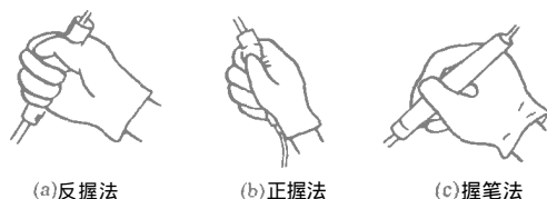
图 2.8 电烙铁的三种握法
