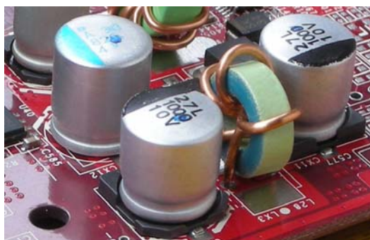
图 1-17 主板上的电解电容
