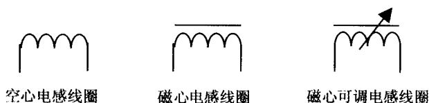
图 1.3.13 电感器图形符号
