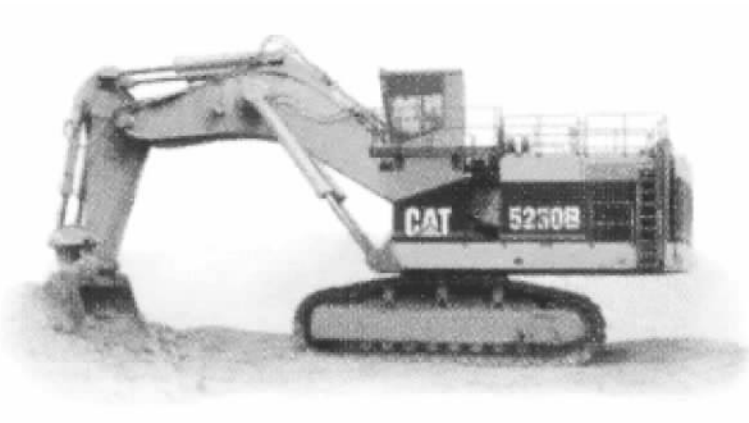
图 1-6 单斗履带式液压挖掘机外形图
