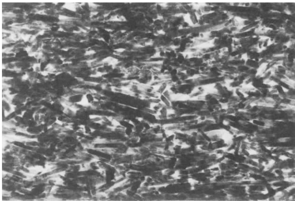
图 1.1 由取向 \text{CrO}_2 颗粒组成的磁带剖面的 TEM。(经 Eber-hard Köester, BASF, Ludwigshaven, Germany 允许。)
