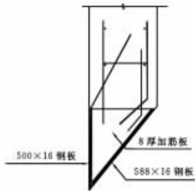
图 1-10 沉井刃脚钢板包裹加固图
