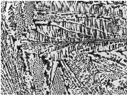
图 1-15 低温莱氏体显微组织结构
